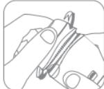
2.研磨ディスク、集塵タンク、フィルターを水道水で洗い流し、よく乾かしてから元に戻してください。
