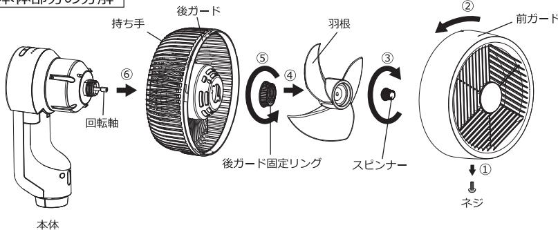
① 前ガードの下にあるネジをドライバーで外します。
