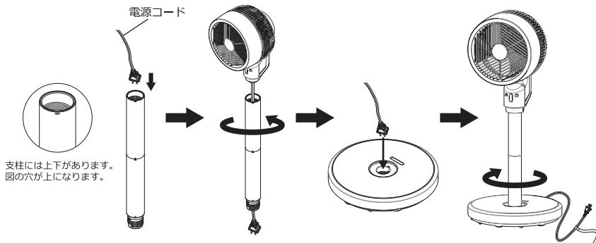
5.スタンドの裏面にあるコードガイドに電源コードを通して、スタンドの切れ目から出します。
