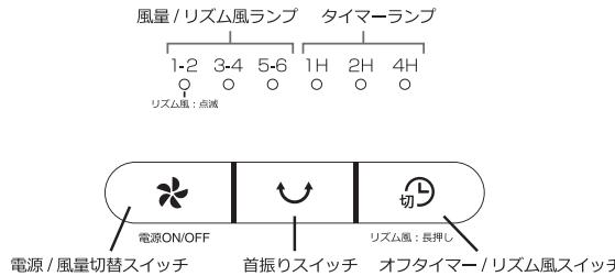
2.電源/風量切替スイッチを押すと風量1で稼働します。
