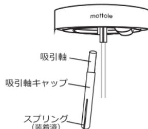
②吸引軸キャップ、吸引軸、スプリング、タンク内
