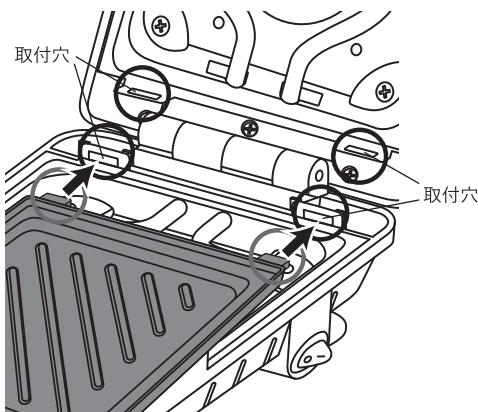
本体のプレート取付穴に、加熱プレートの突起を差し込み、上から押さえて取り付けてください。
