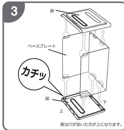
3. 扉を平らな面に裏側にして置き、コの字に曲げたベースプレートを差し込みます。同様に反対側も差し込みます。
