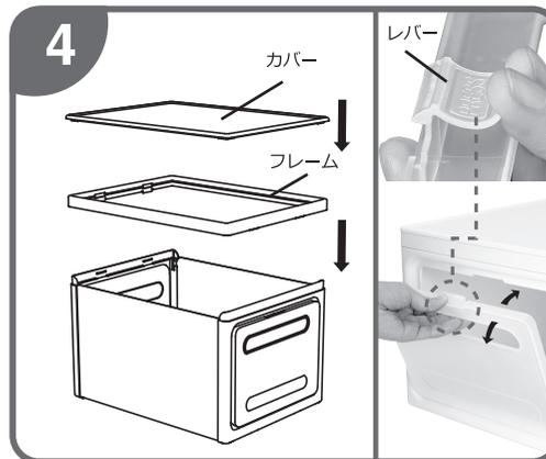
4. 組み立てた 3 を上向きに置き、フレームをはめ込みます。その上にカバーを乗せて完成です。
